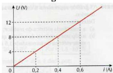
**Fig. 2:** Curva característica de um resistor ôhmico de resistência  $20\text{V/A}$  (ou  $20\Omega$ ) representado na tabela 2 (RAMALHO JUNIOR, FERRARO e SOARES, 2005).
