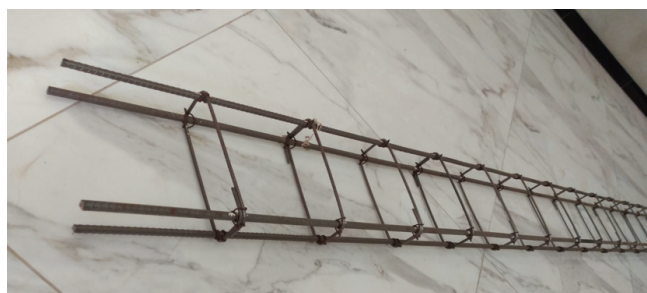
Figura 27: Ferragem armada pronta para ser utilizada em uma construção.
